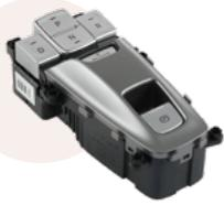
Button Type E-Shifter는 Button 조작으로 차량 구동 시 운전자의 변속 의지를 Automatic Transmission에 전달하는 역할을 합니다.
